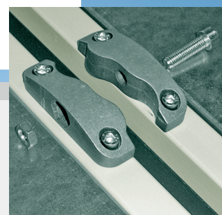
INTERNE GEHÄUSEVERBINDUNGEN DER EINZELNEN SEKTOREN
